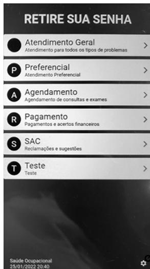
Clique na engrenagem localizada na parte inferior esquerda do visor touch conforme indicado na figura.
