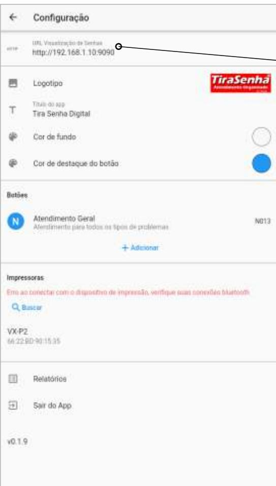
Verifique nas configurações do sistema o endereço da URL para visualizar as senhas em um PC conectado na mesma REDE. No PC, abra um navegador de internet e digite o endereço exibido no visor do seu dispositivo conforme a imagem.
